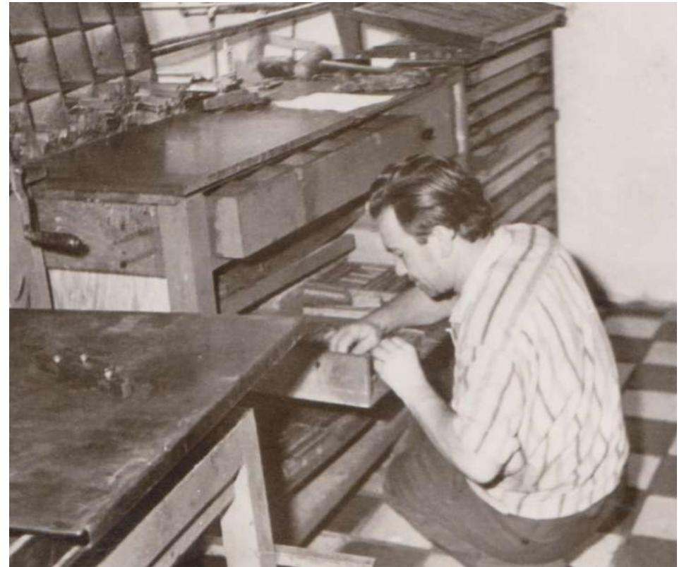
Tipógrafo en el proceso de armada de página con tipos móviles, puede apreciarse al fondo el Chivalete y al frente la mesa de armado.
